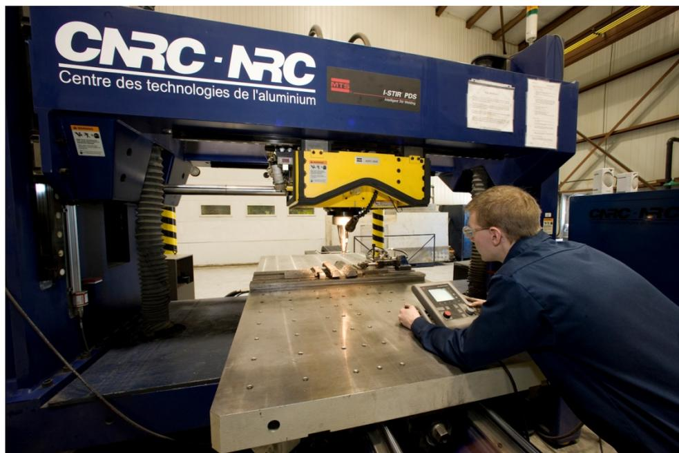
Appareil de soudage par friction-malaxage du CTA-CNRC
