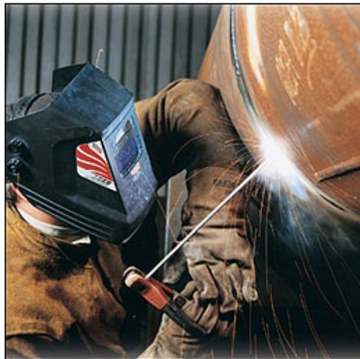
La **baguette** fond dans le **bain de fusion** formant ainsi la soudure, l'enrobage de l'électrode (laitier) fond à la température de l'arc et protège la soudure contre l'oxydation.
