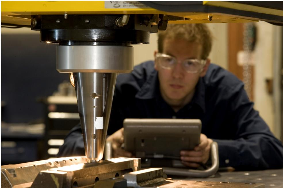
Agent technique réalisant une soudure par friction-malaxage.
