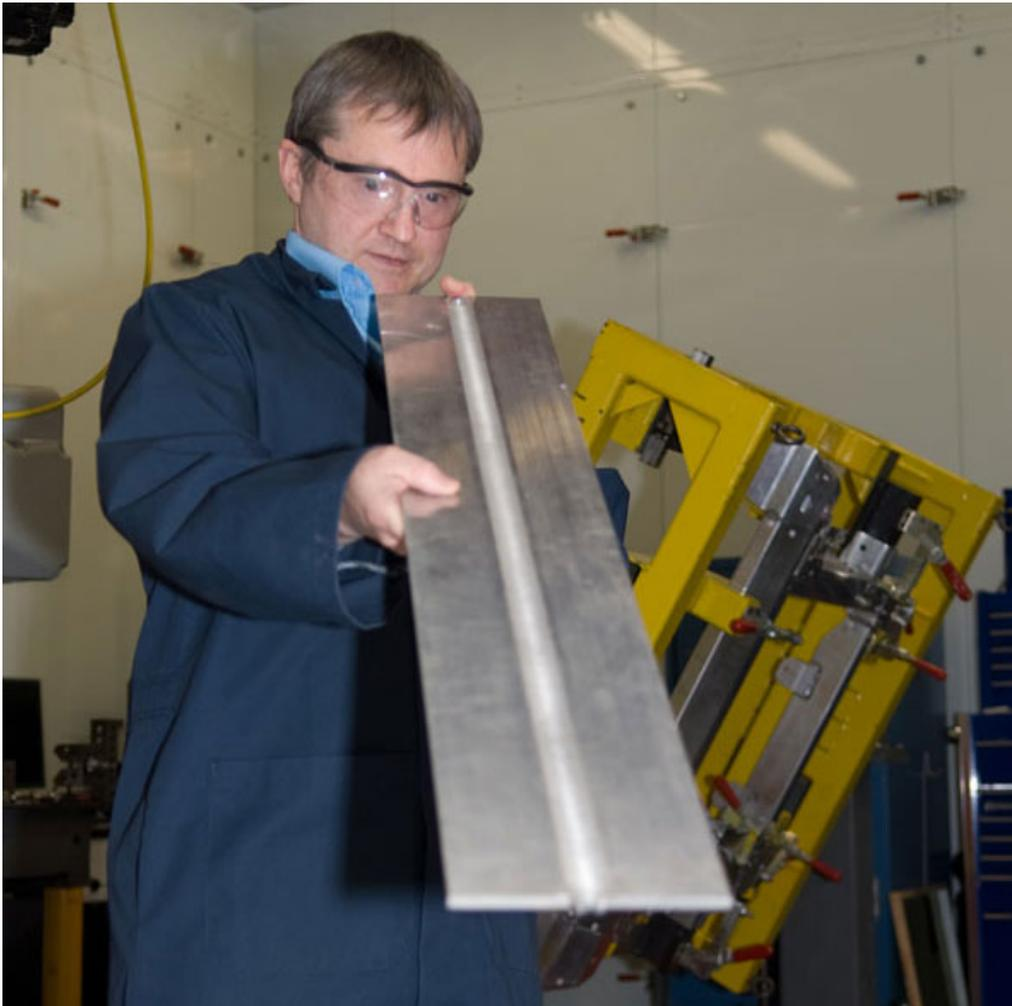
Soudure bout à bout d'aluminium de 8 mm d'épaisseur
