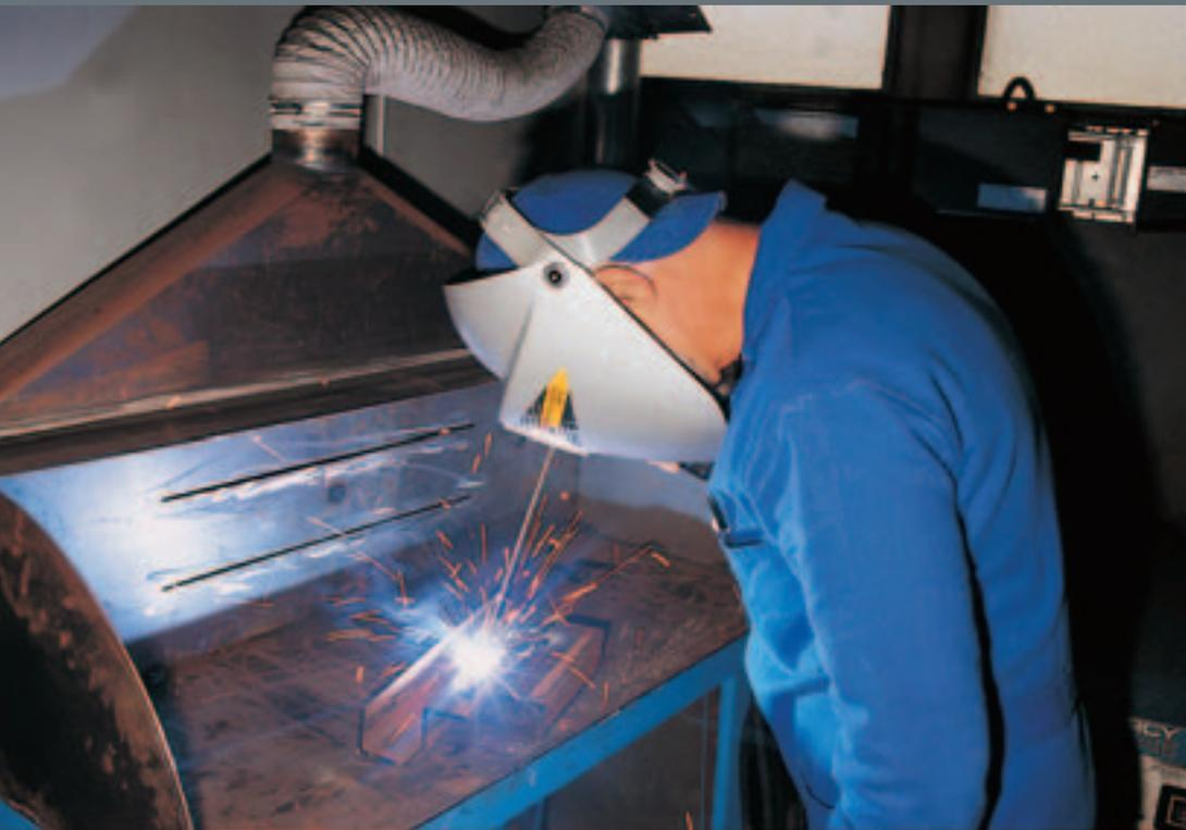
*Le soudage manuel à l'arc avec électrodes enrobées permet d'assembler ou de recharger des éléments ou des pièces métalliques au moyen de cordons de soudure. L'énergie nécessaire à la fusion du métal est fournie par un arc électrique jaillissant entre les pièces à souder et une électrode fusible fournissant le métal d'apport.*
