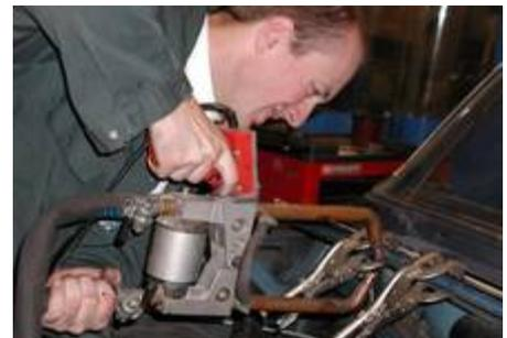
Le diamètre de contact de l'électrode doit être d'environ **2 fois l'épaisseur de la pièce à souder + 3 mm** et sont chanfreinées (angle de **120°** )
