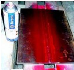
1) Nettoyage de la surface à ressuier et application du pénétrant, laisser pénétré 10 à 40min.
