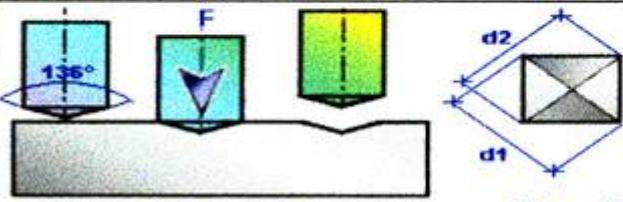
$HV = 0,189 \times \frac{F}{d \times d}$ $d = \frac{d1 + d2}{2}$                                                   | <p style="color: red;"><b>Essai Vickers - HV</b></p> <p>Le pénétrateur est une pyramide droite à base carrée et d'angle au sommet de <math>136^\circ</math> sous une charge <math>F</math>. On mesure les diagonales "d" de l'empreinte.</p>                                                                                                   |
