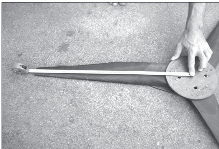
Fixez légèrement le disque avec 3 vis pour maintenir les pales. (Une vis par pale).
