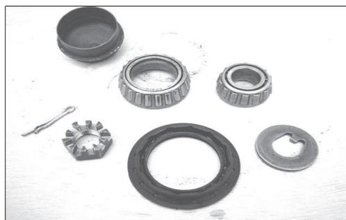
Roulements et joints SPI
