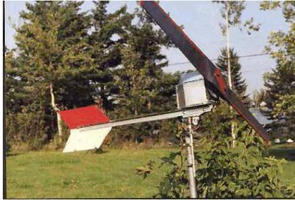
Ici nous avons une nacelle pour prise directe d'un alternateur auto modifié ou d'une génératrice CC qui sont aptes a produire a relative basse vitesse ou engins modifiés. (500 a 1000 tm)
