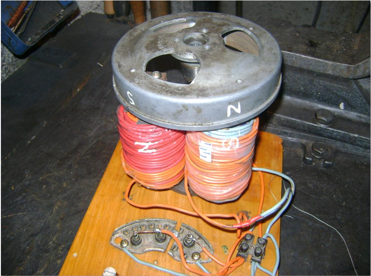
Une fois le volant en place, on ferme l'interrupteur brièvement: une impulsion d'une seconde suffit.
