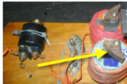
Pour une magnéto ou un volant inconnu, il faudra changer ces pièces pour d'autres aux caractéristiques proches de celles du volant.
