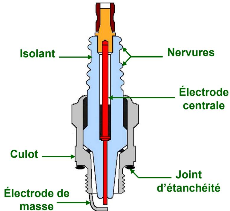
Elles fournissent l'énergie nécessaire pour amorcer la combustion du mélange gazeux grâce à des étincelles électriques jaillissant entre leurs électrodes.
