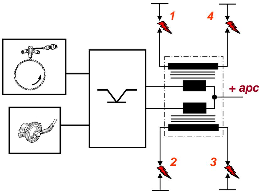
A partir des informations données par le capteur vilebrequin et la capsule manométrique, le calculateur d'allumage détermine la durée de remplissage bobine et le point d'allumage.
