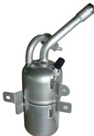
L'humidité, la température et le R134a produisent de l'acide hydrofluorique et chlorhydrique. Les couches de gel de silice (dessicant) dans le FDR absorbent de petites quantités d'humidité, évitant ainsi la formation d'acide.
