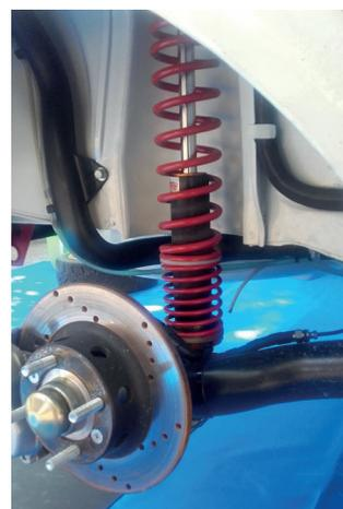
Fig. 3.31. Exemple de montage en série : un ressort principal et un ressort compensateur.
