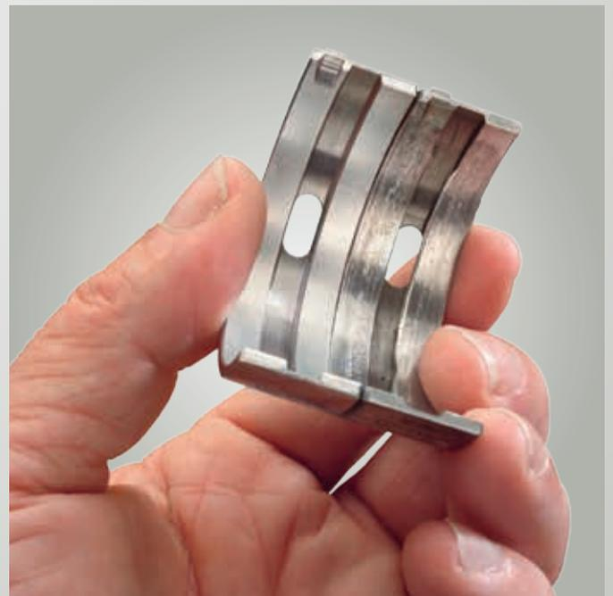
*Fig. 3 : Comparaison du vieux coussinet et du coussinet neuf*
