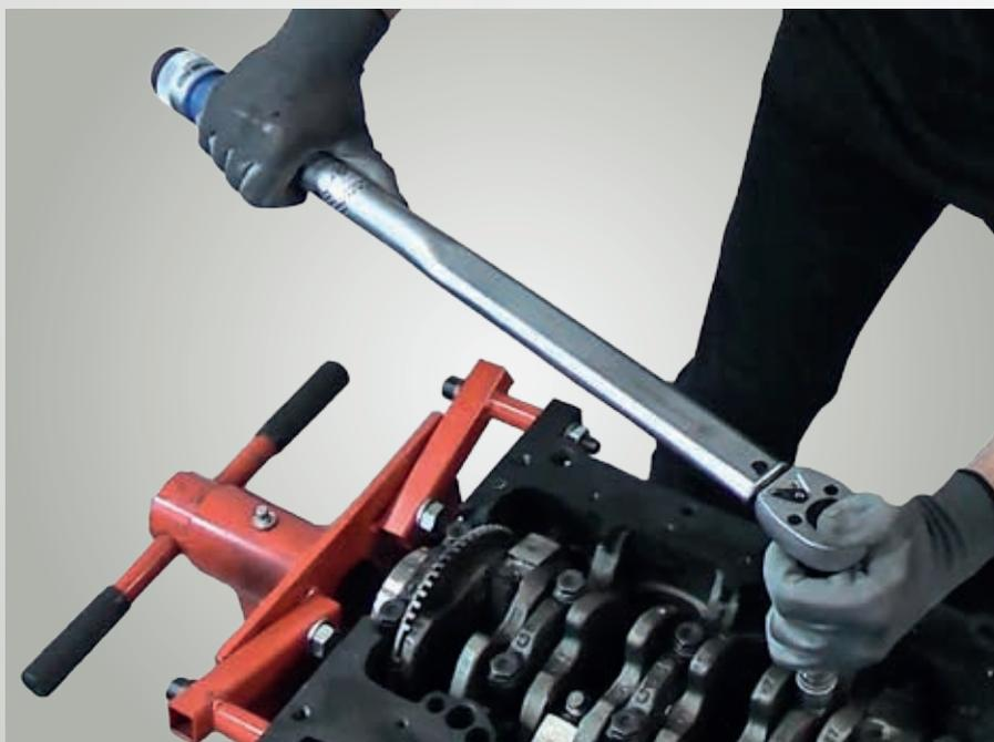
Fig. 1 : Serrage des vis selon les instructions du constructeur
