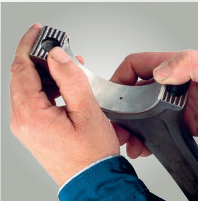
*Fig. 2 : Documenter le siège et la position des coussinets*
