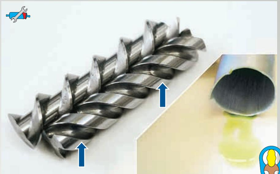
*Fig. 55 : Calaminage dû à l'emploi d'un produit non homologué
