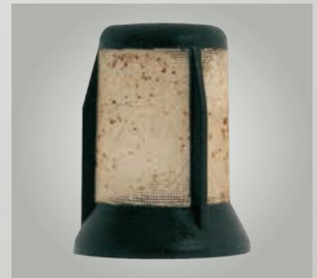
Fig. 23 : Filtre-tamis encrassé sur une pompe à engrenage E3T
