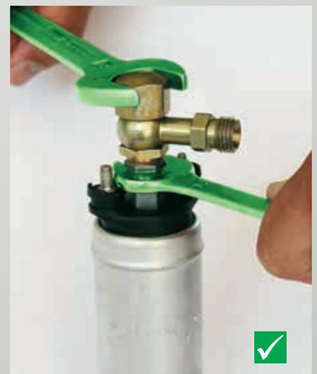
Fig. 71 : Montage correct : il faut contrer le six pans inférieur de la pompe à carburant
