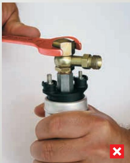
Fig. 70 : Mauvais montage : Serrer sans contrer
