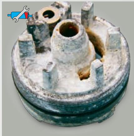
Fig. 50 : Palier extérieur rouillé d'une pompe à carburant
