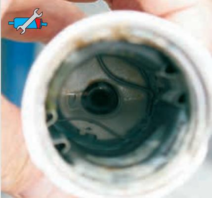
Fig. 44 : De l'eau dans une pompe à carburant
