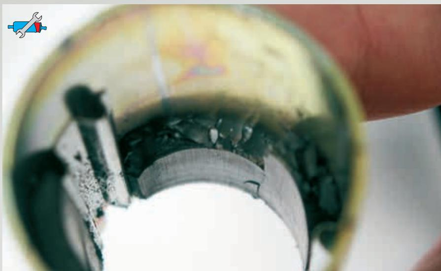
*Fig. 80 : Aimant permanent cassé (stator)*
