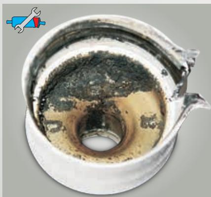
Fig. 18 : Vue à l'intérieur du boîtier découpé d'une pompe à engrenage E3T – encrassée par des dépôts
