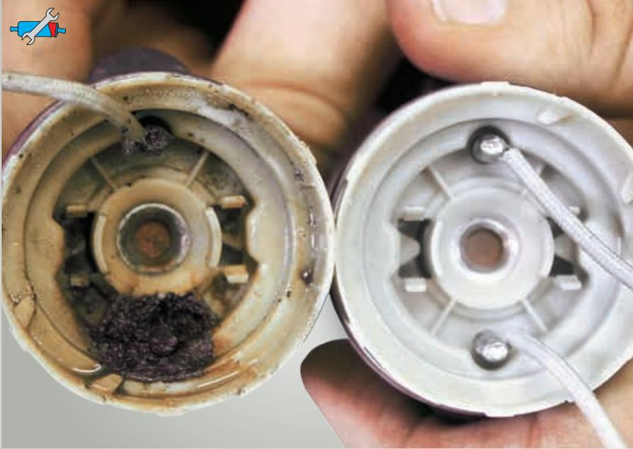
Fig. 46 : à gauche : contacts électriques corrodés ; à droite : neuf
