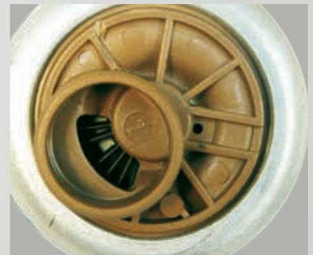
*Fig. 35 : Par comparaison : vue du manchon d'aspiration d'une pompe à canal latéral avec une roue d'engrenage intacte (ci-dessous).*
