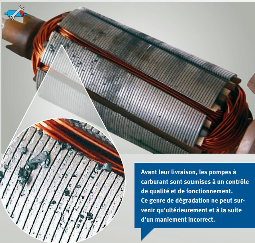
Avant leur livraison, les pompes à carburant sont soumises à un contrôle de qualité et de fonctionnement. Ce genre de dégradation ne peut survenir qu'ultérieurement et à la suite d'un maniement incorrect.
