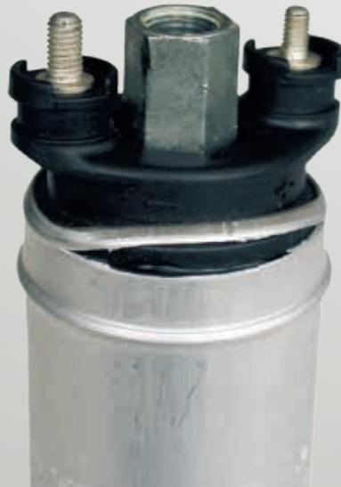
*Fig. 1 : Dégât provoqué par un choc
