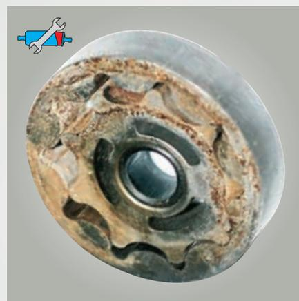
Fig. 53 : Par comparaison : un mécanisme de pompe trochoïde rouillé
