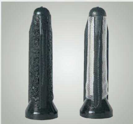
Fig. 22 : Filtre-tamis d'une pompe à ailettes E1F à gauche bouché – à droite, neuf
