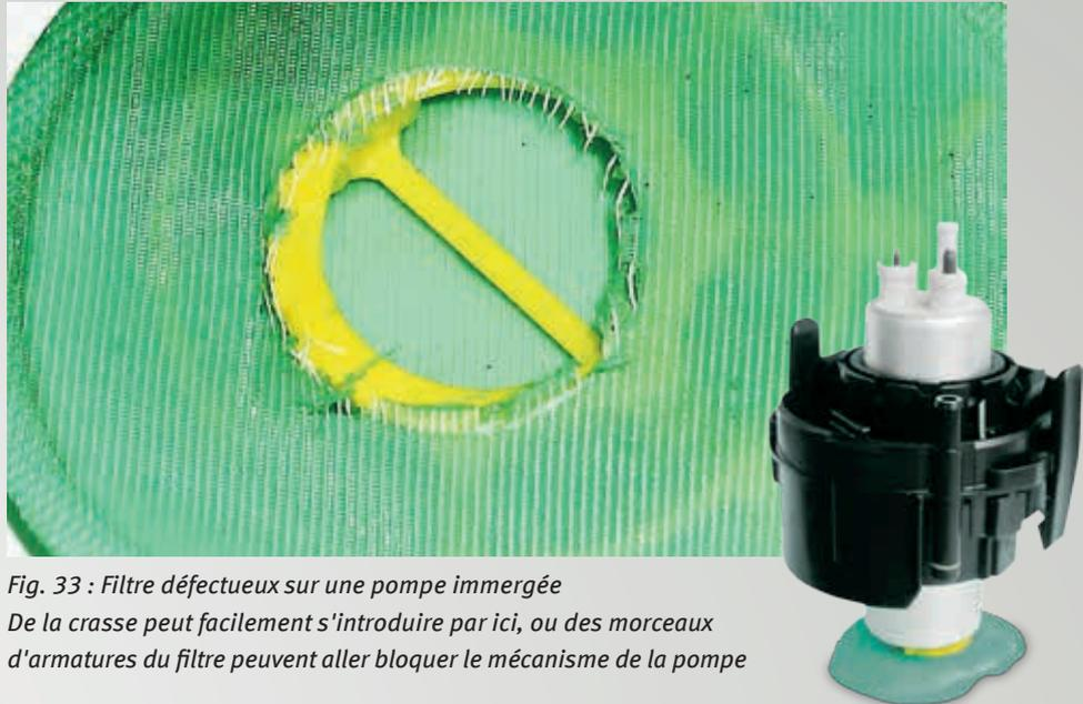
*Fig. 33 : Filtre défectueux sur une pompe immergée
