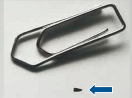
Fig. 27 : Corps étranger ayant provoqué le dommage (comparé à un trombone)
