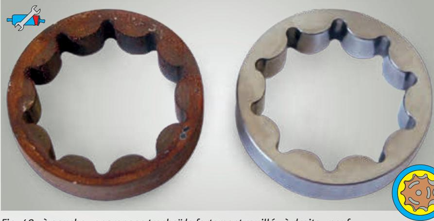
Fig. 48 : à gauche : engrenage trochoïde fortement rouillé ; à droite : neuf
