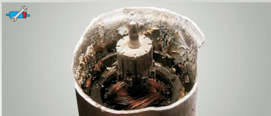
*Fig. 16 : Pompes à carburant électrique fortement rouillées*
