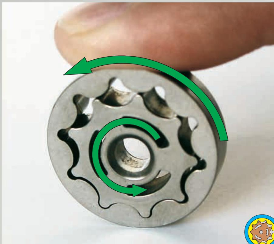
Fig. 52 : Un mécanisme de pompe trochoïde doit toujours pouvoir tourner librement
