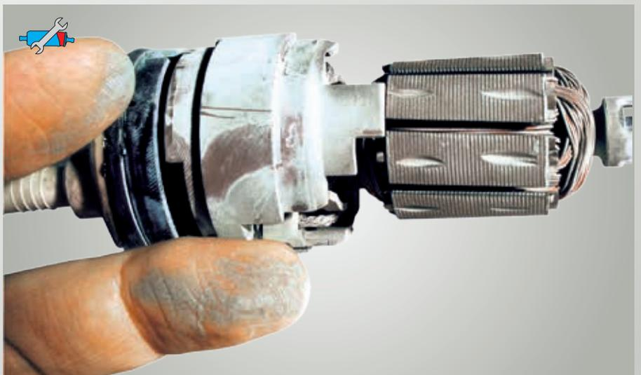
*Fig. 56 : Dépôt de carburant de mauvaise qualité*
