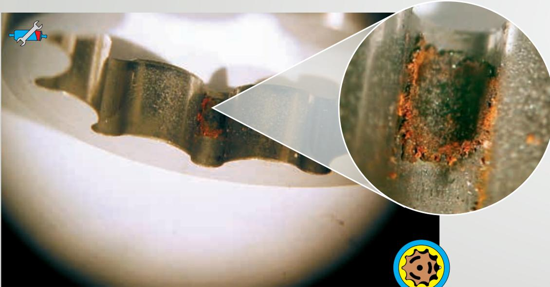
Fig. 47 : Engrenage trochoïde bloqué par des particules de rouille (agrandissement)
