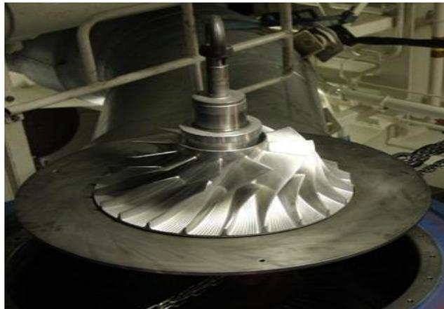
Figure III. 8. Compresseur centrifuge
