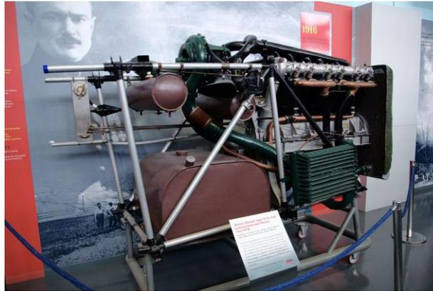
**Figure.III.1.Moteur Renault 12 Fe équipé d'un turbocompresseur Rateau.**
