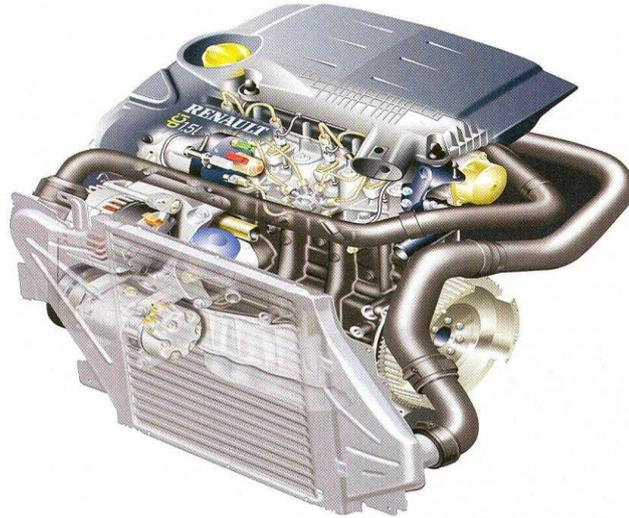
**Figure I.1. Moteur Renault 1.5 l dCi**
