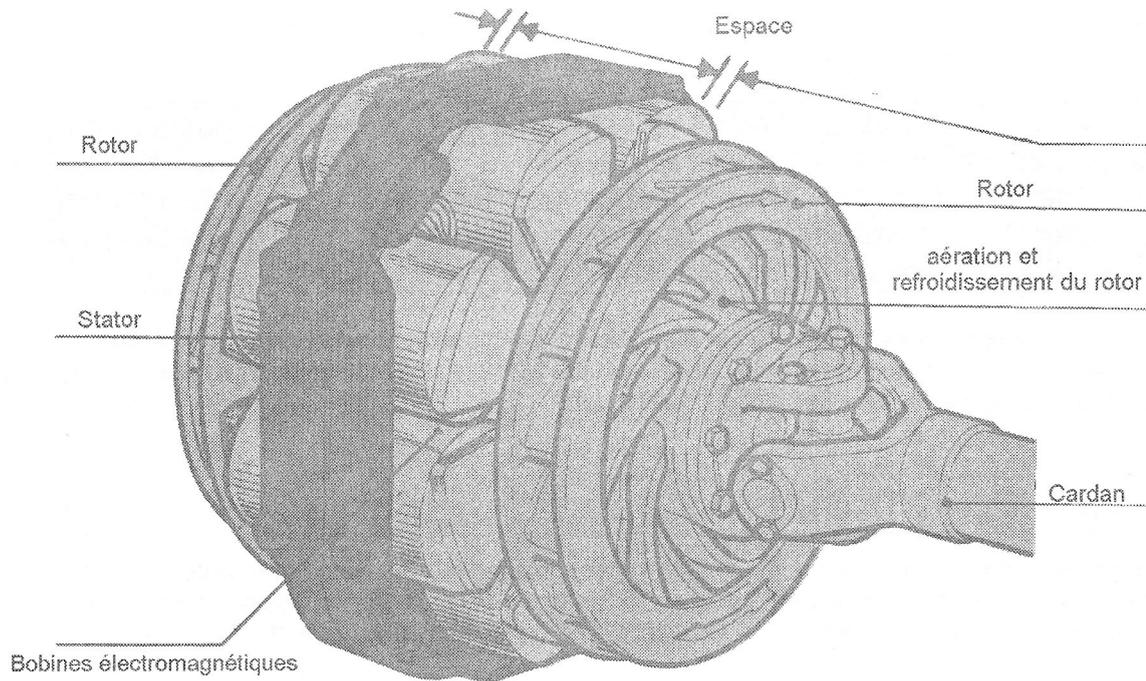
Le frein électromagnétique se trouve sur le cardan, à la sortie de la boîte de vitesses ou à l'entrée du pont.
