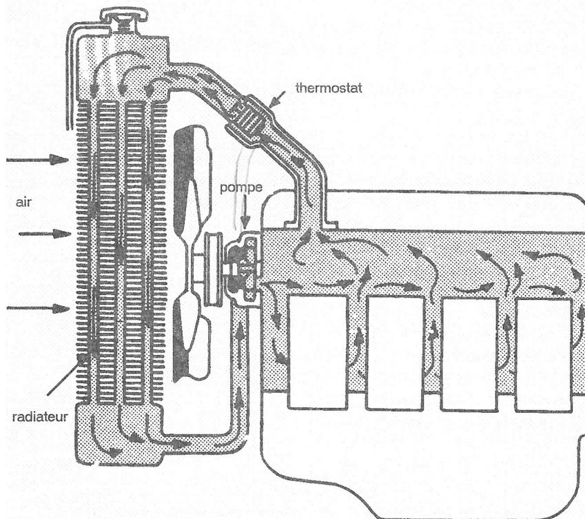
Les chambres de combustion sont enrobées par des conduites d'eau. L'eau absorbe la chaleur et elle est refroidie dans le radiateur. L'eau refroidie retourne dans le moteur. Un ventilateur améliore le refroidissement, surtout lorsque le véhicule est à l'arrêt ou s'il roule à basse allure.
