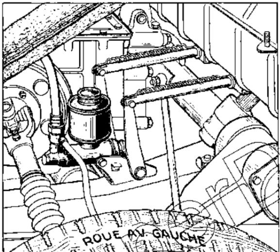
Fig. 2. — RÉSERVOIR DU LIQUIDE POUR FREINS
