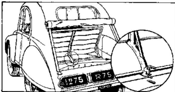
Fig. 24. — DÉPOSE DE LA BANQUETTE AR
