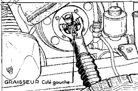
Fig. 16. — (1 graisseur à droite et 1 à gauche) (20 à 30 coups de pompe)
