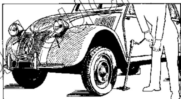
Fig. 11. — POSITION DU CRIC A L'AVANT (ET DE LA CALE AU)
