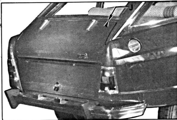
**3. Regular el engranaje de la cerradura de la puerta de maletero, desplazando la cerradura o el cerradero en sus botoneras.**
