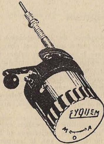
Fig. 96. — Essuie-vitre électrique adaptable (Eyquem)
