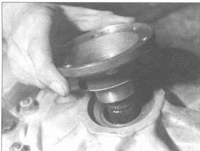
9.100b . . . push the drive flange onto the shaft . . . publié sur www.wikidoc.cc
