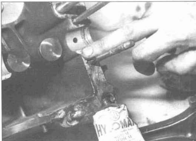
32.10 Apply sealant to the mating surfaces of the crankcase publié sur www.wikidoc.cc
