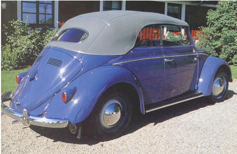
Pour certains puristes, les coccinelles modèles '58 - '60 sont les dernières Volkswagen « classiques ». Dès le modèle '61, des éléments tels que les flèches, le moteur « pied moulé » 30 chevaux et la cloison derrière la roue de secours, identiques à celle des splits, auront disparu.
